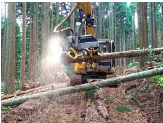
図-1 ハーベスタによる採材状況
